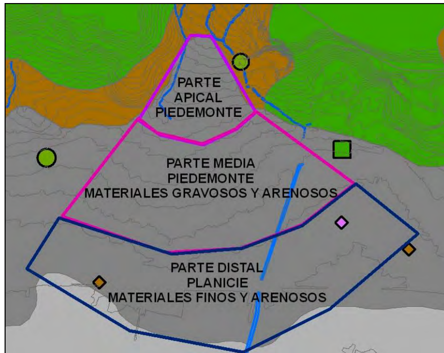
Figura 4.14. Interpretación geotécnica de unidades de abanicos aluviales
