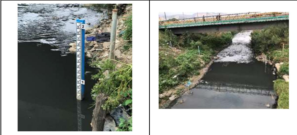
Foto de la izquierda se muestra una sección de miras, foto de la derecha se muestra la ubicación de las miras en la sección transversal del cauce en la estación San Benito en la localidad de Tunjuelito. Toma del 14-02-2020.
