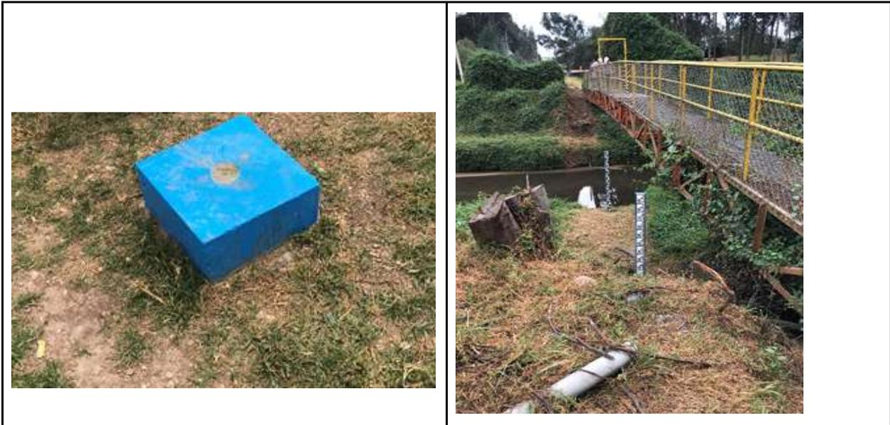
Foto de la izquierda condición final del BM, foto de la derecha se muestra una sección de miras de la estación Gravilleras en la localidad de Ciudad Bolívar. Toma del 14-02-2020.
