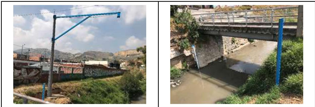
*Foto de la izquierda vista general del soporte del sensor, poste y Brazo, foto de la derecha se muestra la sección de miras de la estación San Francisco en la localidad de Ciudad Bolívar. Toma del 14-02-2020.*
