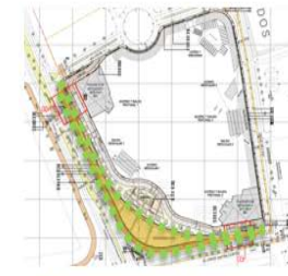
Adecuación de Andenes perimetrales
