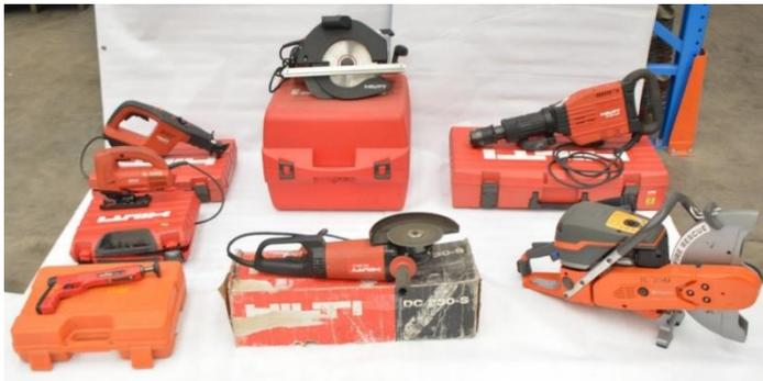
Kits de equipos de corte y perforación para rescate vehicular y en estructuras colapsadas
