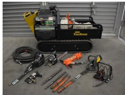
Equipo hidráulico de demolición
