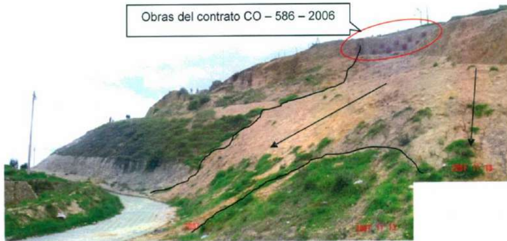
Fotografía No. 10. Parte central del barrio Brisas del Volador . Unidades geomorfológicas "Laderas intervenidas por actividad extractiva" y "Escarpes mecanizados". Afloramientos rocosos del Grupo Guadalupe – Formación Arenisca Tierna – Unidad de areniscas friables y Unidad de areniscas macizas superiores. Se observan evidencias de antiguo desprendimiento de materiales.
