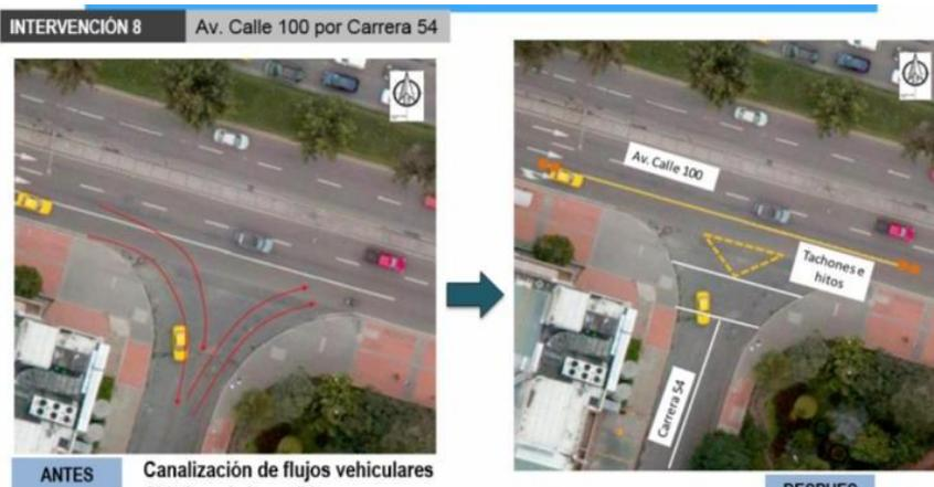
9. Avenida Calle 68 entre Carrera 50 y Carrera 54; canalización de flujos vehiculares, instalación de barrera viva y semáforo peatonal en el tramo de la Av. Calle 68 entre cra 50 y cra 54 y la intersección de la Av. Calle 68 por cra 52 respectivamente, para canalizar y regular paso peatonal y mejorar movilidad en el sector.
