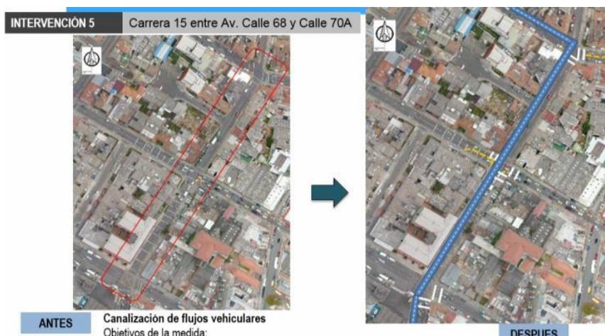
6. Calle 67 entre Carrera 19 y 20; canalización de flujos vehiculares, reducir conflicto de flujos vehiculares, canalizar los movimientos permitidos en las intersecciones, mejorar condiciones de paso peatonal y de ciclistas
