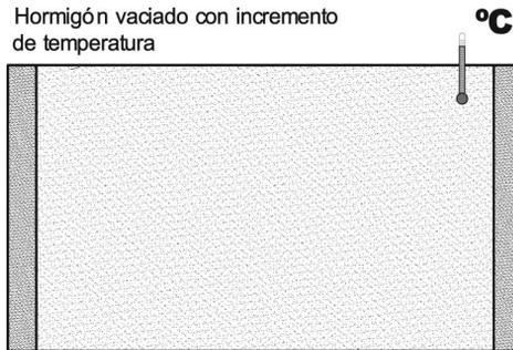
Cuando el concreto se enfría, se contrae. Si existen restricciones al movimiento, el concreto se fisura.
