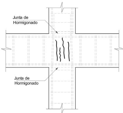
**FISURACIÓN EN COLUMNAS POR AGOTAMIENTO DE LA RESISTENCIA DEL HORMIGÓN**
